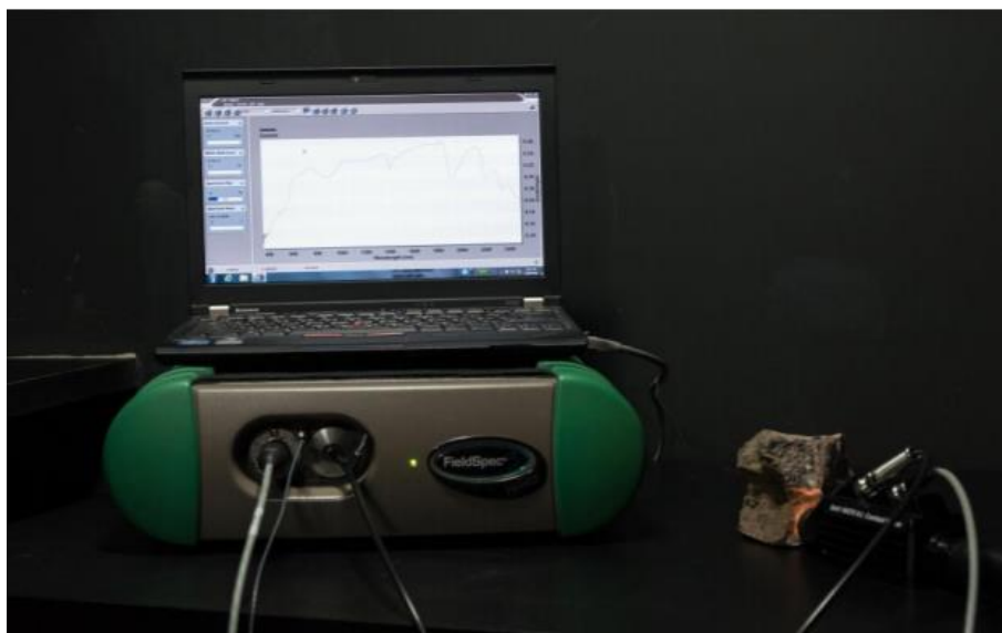
Figura 3. Espectrorradiômetro ASD-FieldSpec 3 Hi-Resolution, no Laboratório de Espectroscopia Mineral na SUREG-SP (retirado de Guerra, 2019).
