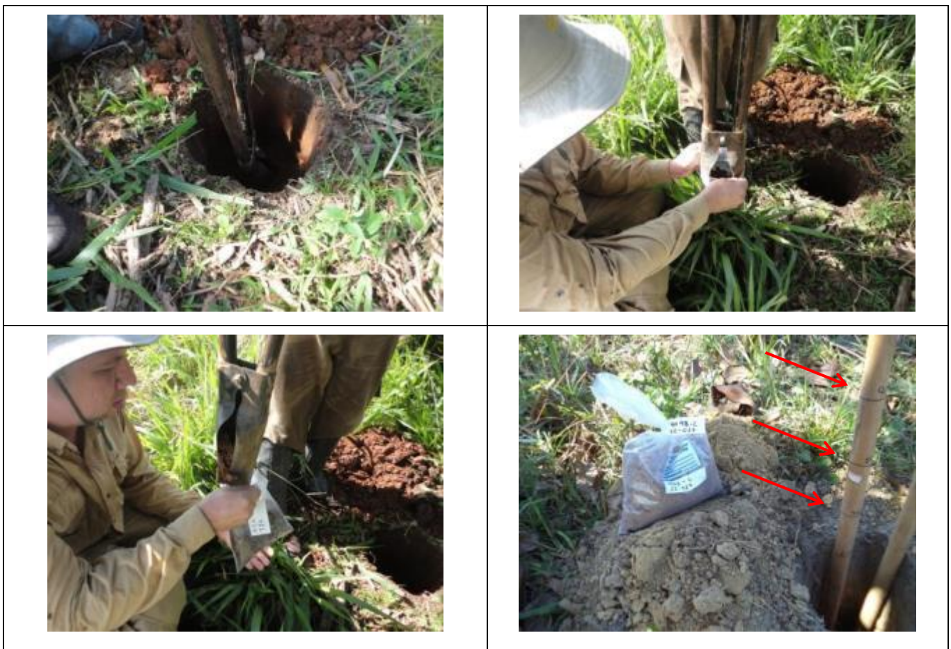
Foto 1A – Local de coleta de amostra de solo. B/C – Etapa de armazenamento da amostra. D – Amostra devidamente embalada e identificada e setas vermelhas mostrando graduação do trado.
