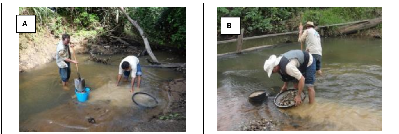
Figura 3 – Coleta de amostra de concentrado de bateia em concentradores naturais. A) Amostragem após antigos troncos de árvores. B) Amostragem em sombra de matação. C) Amostragem em ponta de banco de cascalho. D) Amostragem em trecho retilíneo da drenagem com concentração de blocos.
