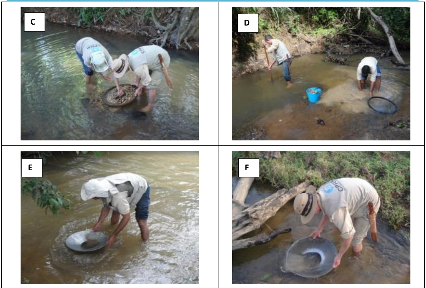
Figura 4 – Etapas do processo de amostragem de concentrado de bateia. A) Coleta de amostra utilizando balde de 10 Litros. B) Peneiramento da amostra. C) Verificação do material retido na peneira (oversize). D) Deslamagem da amostra. E/F) Ponto exato onde se deve parar de batear.
