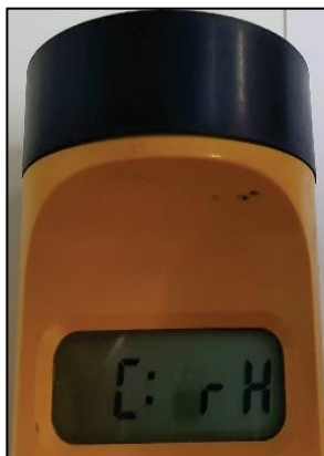
Figura 3 – Visor do KT-9 exibindo o modo rH (operação com botão direito).
