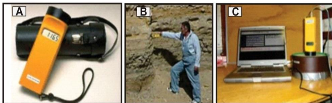
Figura 1 – A) Kappameter KT-9 com o invólucro para transporte. B) Operação do kappameter KT-9 em afloramento de rocha. C) Conexão do kappameter KT-9 com um notebook.
