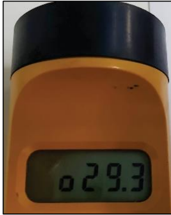
Figura 5 – Visor do KT-9 mostrando exemplo de valor médio das leituras registradas.
