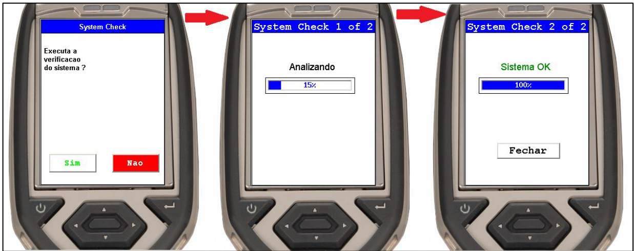
Figura 20 – Etapas de checagem de sistema. À esquerda a mensagem que aparece no display perguntando se o usuário deseja fazer uma verificação do sistema. No centro, a tela exibida enquanto o analisador testa o sistema. À direita a mensagem aparece no final caso à checagem não tenha encontrado nenhum problema.
