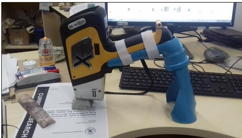
Figura 12 – Exemplo de suporte elaborado para análises em testemunho de sondagens
