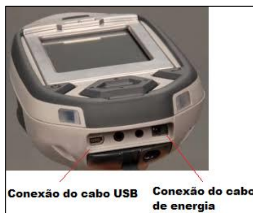
Figura 24 – Imagem mostrando a localização das conexões do cabo USB e da fonte de energia do FRXp Niton.
