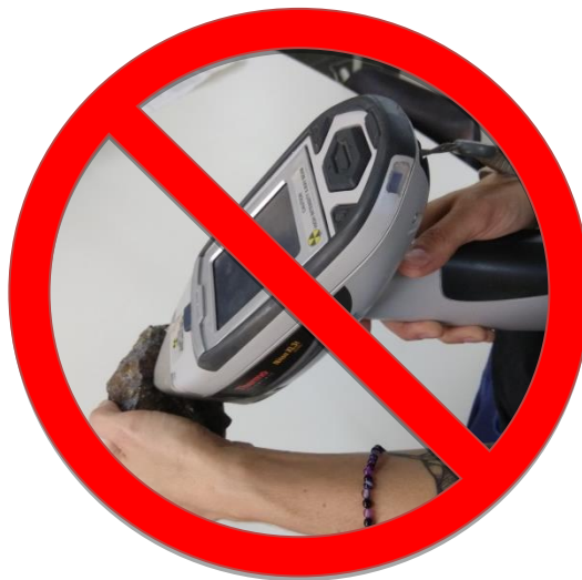
Figura 10 – Jamais faça uma análise apoiando a amostra em uma das mãos
