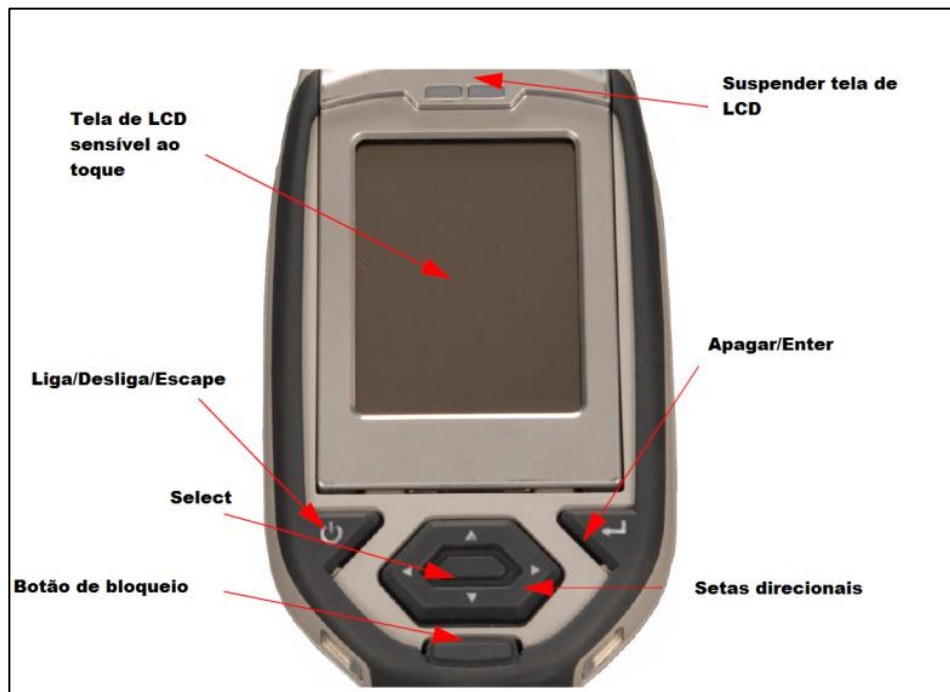
Figura 17 – Diagrama explicando as funções de cada objeto no painel de controle do FRXp
