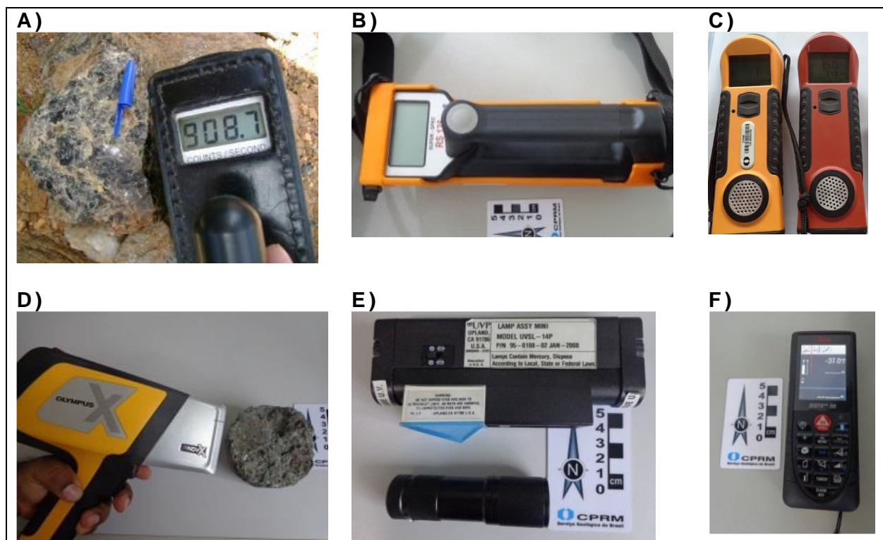
Figura 2 – Equipamentos portáteis passíveis de serem utilizados nas as atividades de campo. A) Cintilômetro; B) Gamaespectrômetro; C) Susceptibilímetro (amarelo) e susceptibilímetro/conduvívímetro (vermelho); D) Fluorescência de Raios-X; E) Dois modelos de Mineralight ; F) Mira a laser.
