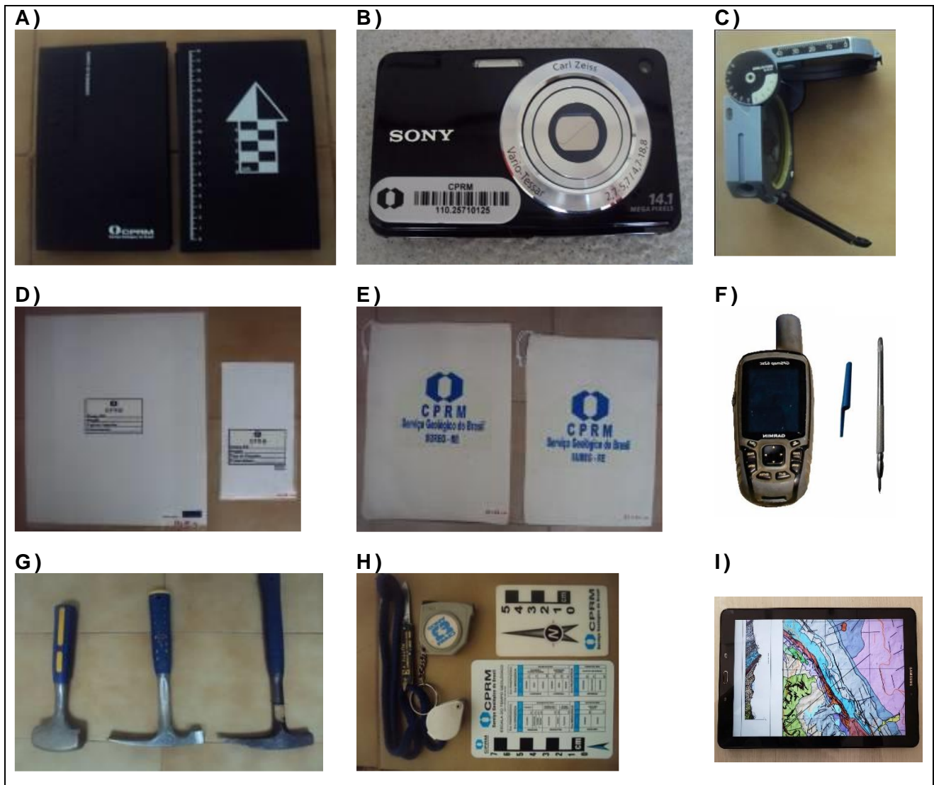
Figura 1 – Fotografias de alguns materiais utilizados em atividade de campo. A) Caderneta de campo; ; B) Máquina fotográfica; C) Bússola; D) Saco plástico para amostra; E) Saco de pano para amostra; F) GPS e riscador de rocha com imã; G) Martelos, H) Canivete, lupa, trena e escala para fotos; I) Tablet .
